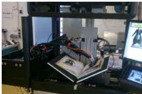
Automatic book scanner with 2 DOF Automatischer Buch Scanner mit 2 DOF (EPS GmbH)
