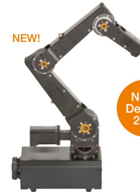
Robots with direct driven gears made from plastic ... various connector modules ... Roboter mit direkt-angetriebenen Kunststoff-Getrieben ... verschiedene Verbindungsmodule ...
